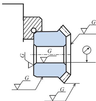
高精度に追加工をして頂くためにハブ外周及び、端面を研磨仕上げしています。
