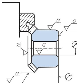
高精度に追加工をして頂くために歯先外周及び、端面を研磨仕上げしています。
